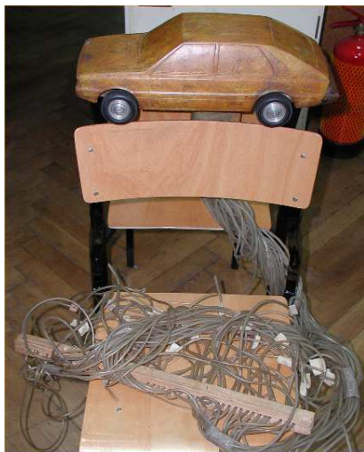
Rys. 7 Model samochodu Polonez z podłączonymi przewodami elastycznymi
